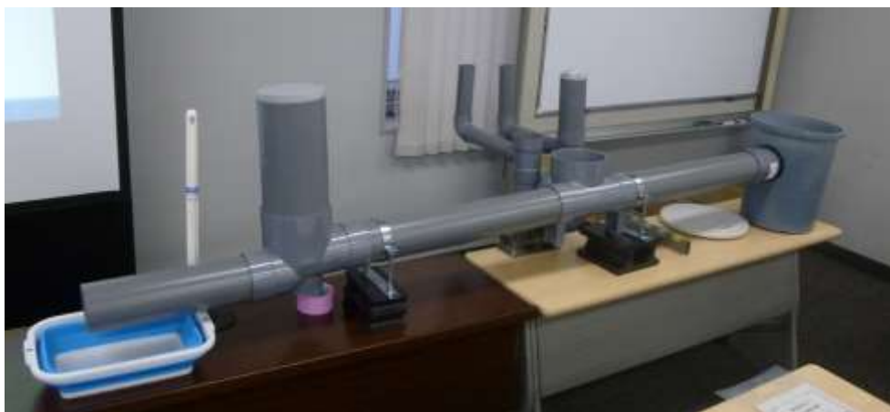
*排水ますと排水管のモデル
